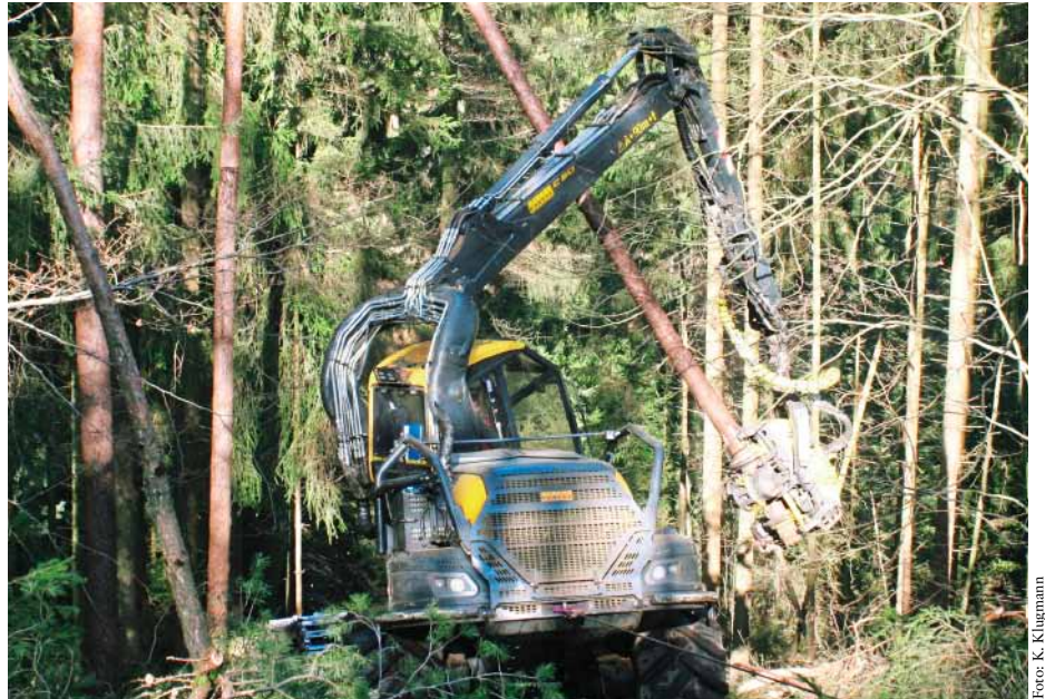
Abb. 1: Holzernte am Hang mit einem Harvester mit Traktionshilfswinde in einem Bestand mit Durchforstungsrückständen und nicht zuletzt dadurch bedingtem, hohem Gefährdungsniveau bei Durchführung im motormanuellen Arbeitsverfahren
